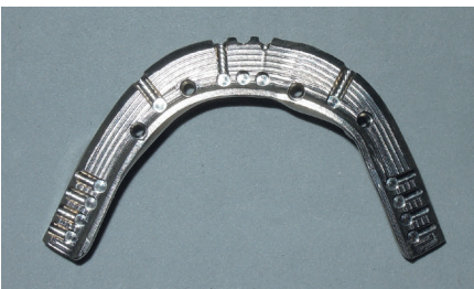
Abb. 8: Die im Fertigungszentrum (Biomet 3i) hergestellte Suprastruktur – Gerüst für die Columbus-Bridge
